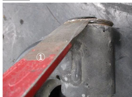
1. No.1、No.2ブシュのフランジを効ネ①で起こす。 (ベアリングリムバの歯を入れるため)(2の拡大写真) アーム側を变形させないように注意
