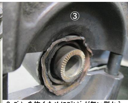
3. ブシュを抜くためにフランジが無い側から ブシュに荷重をかける。その際ベアリングリムバ ③でロアアームを支持出来るよう挟む。
