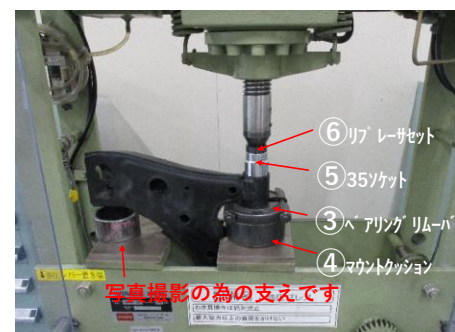
4. 準備工具とロアアームを油圧プレス⑥にセットする。 なお『写真撮影の支え』は実際の作業では不要です。
