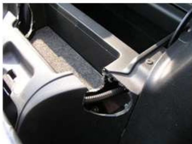
③ 上記の図を参考に糸ノコやリューター等で加工します。(配線などに注意する。)
