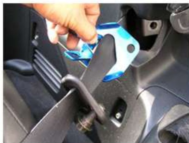
② ステー本体にシートベルトを通して14mmのボルトを仮止めします。(純正ワッシャー2枚を外す。)
