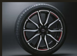
215/45R18タイヤ(ブリヂストン POTENZA RE050A) & 7J専用アルミ ホイール(エンケイ製 ブラック塗装 +切削光輝&リム段差+レーザー 加飾レッドライン仕様) + 専用セン ターオーナメント ※ GR SPORT 専用メーカーオプション
