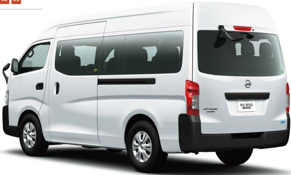
Photo：マイクロバスDX(2WD・ディーゼルトーボ)。 スーパーロングボディ ワイド幅 ハイルーフ 低床 14人乗 4ドア。ボディカラーはホワイト<#QM1>。
