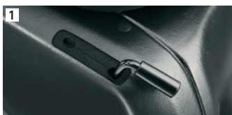
フロントハンドブレーキ 車いす前方からブレーキのロック&解除ができます。
